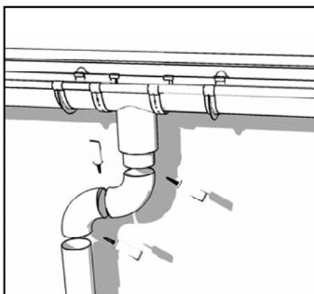
При монтаже центральной воронки, начните установку желоба от нее. Сначала Вы защелкиваете заднюю часть желоба (1), затем внешнюю (2). Маркировки (ограничители) внутри воронки указывают промежуток, который должен оставаться, чтобы компенсировать термическое смещение элементов.
